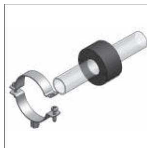
Juster isoleringsskal på røret så den er ud for rørbøjlen.
