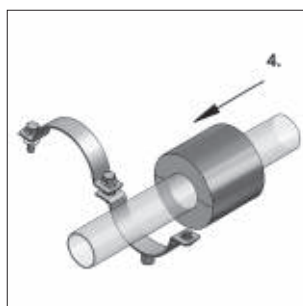
Juster komposit-skal på røret ud for rørbøjlen. Valgfrit: med metalcylinder
