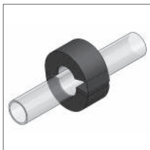
Placer isoleringsskal på røret.
