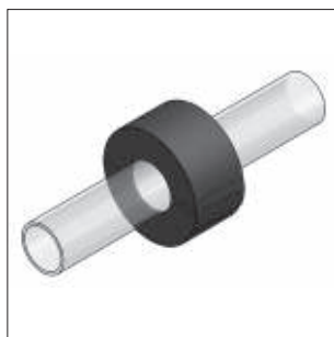
Luk isoleringsskal og tryk overlappning til.
